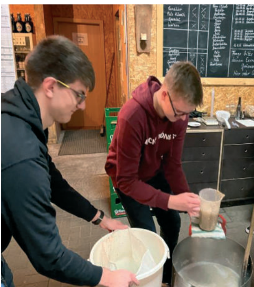
Befüllung der Maische (siehe Topf) in ein Läuternottich (siehe Eimer), um die festen und flüssigen Bestandteile der Maische voneinander zu trennen. Dies wird gemacht, damit nur noch der flüssige Sud überbleibt. Durch diesen Prozess entsteht die Würze des Biers.
